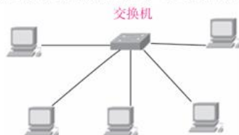
图 1.16 星型拓扑结构
